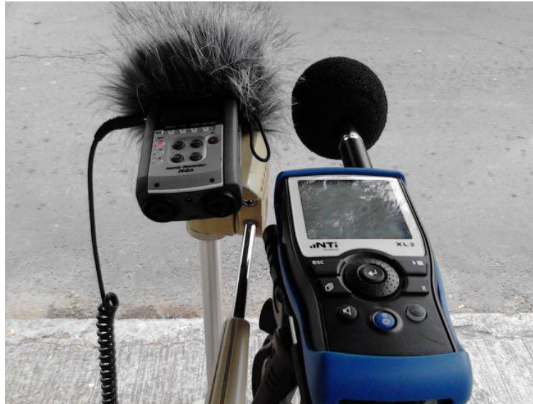
Figura 6. Sonómetro y grabadora zoom durante un registro de ruido vehicular.
