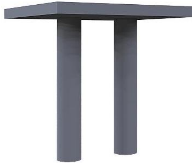
Figura 74. Cimentación por pilotes.
