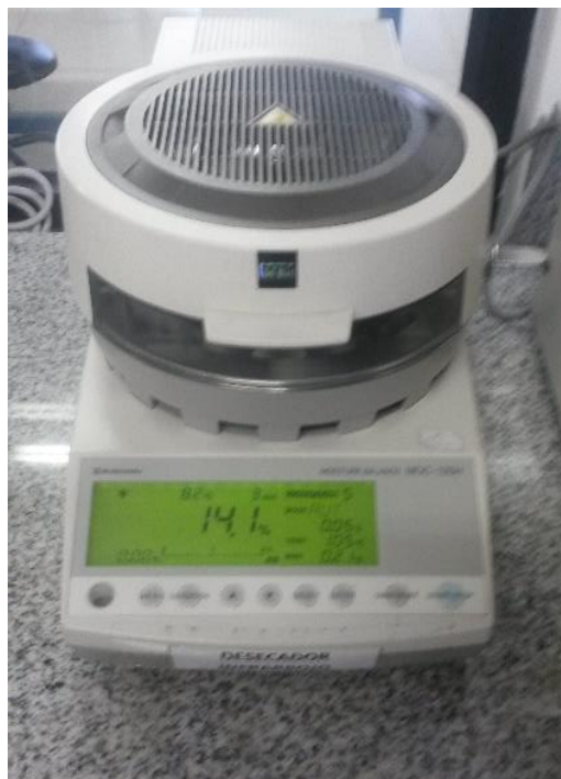
Foto7. Determinación de humedad en desecador infrarrojo
