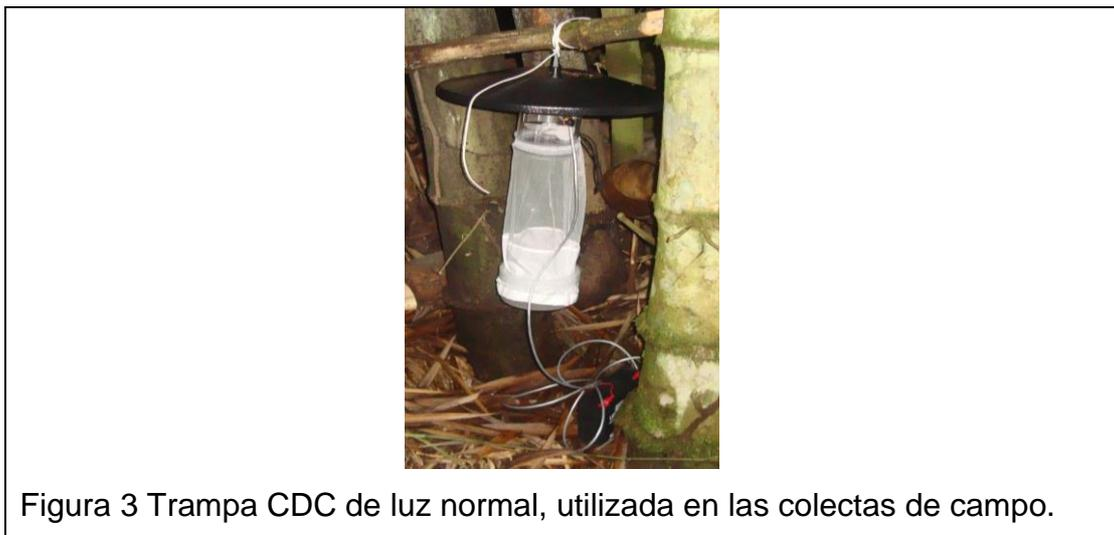
Figura 3 Trampa CDC de luz normal, utilizada en las colectas de campo.
