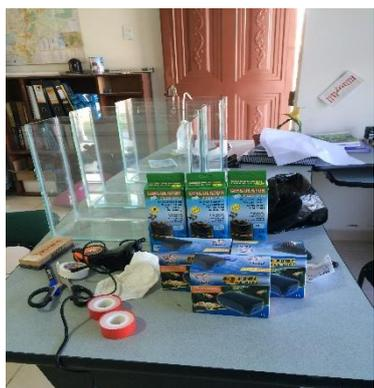
5. Materiales para la construcción de reactores con una capacidad de 5 litros cada uno, motores y bomba de recirculación.
