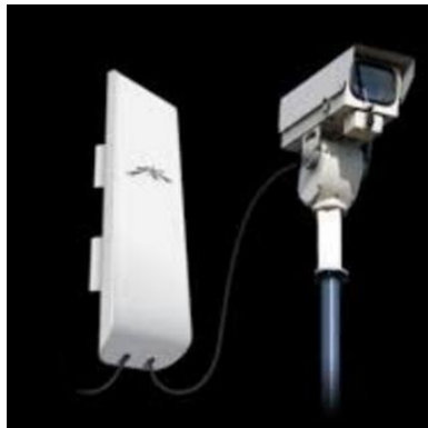
Figura No 38. Conexión de cámara directa al radio.
