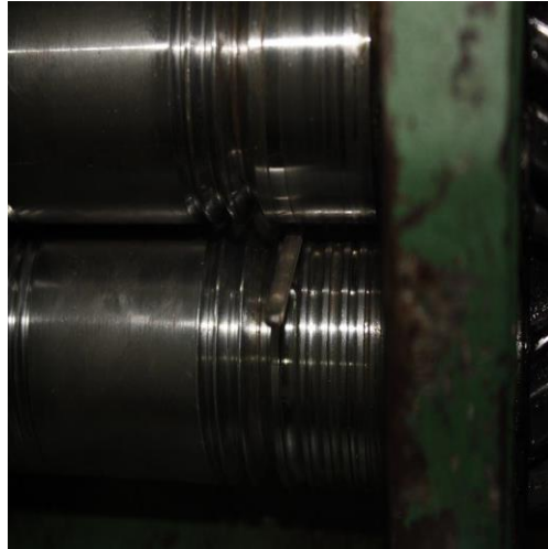
Figura 23. Conformado media caña en barra de plata 950.
