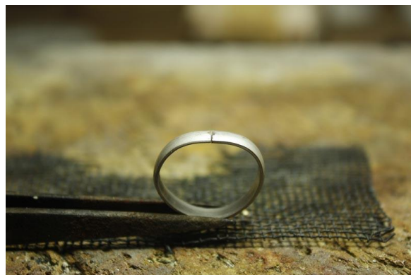
Figura 26. Aro de plata 950 listo para ser soldado.
