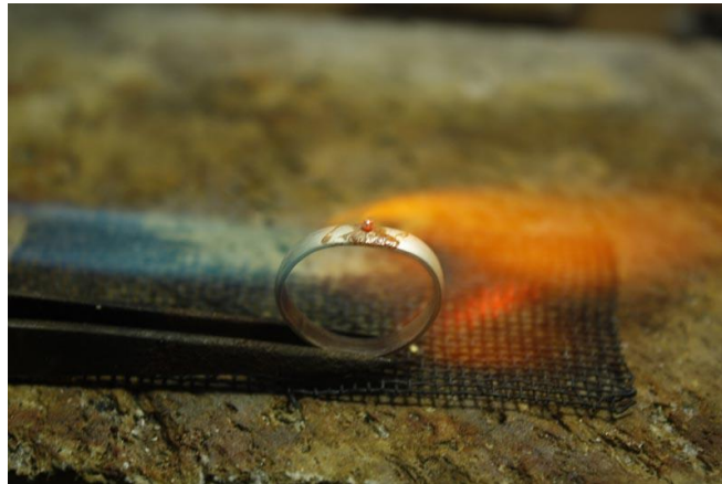
Figura 27. Suelda de aro de plata 950.
