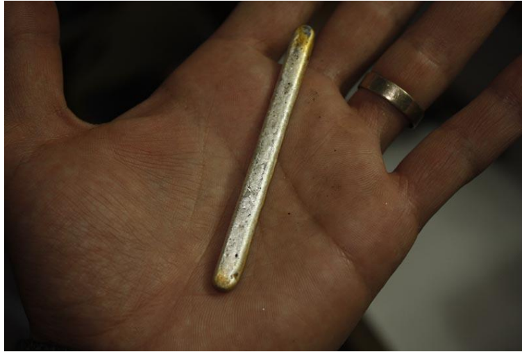
Figura 18. Barra de plata 950 luego de la fundición.
