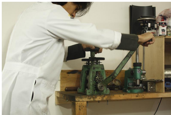
Figura 19. Proceso de laminado manual.
