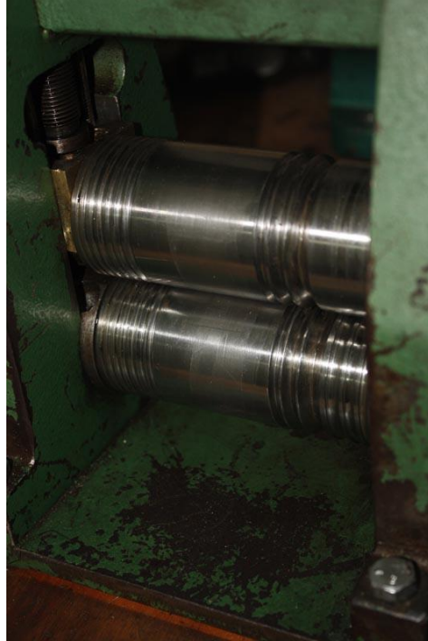
Figura 20. Detalle de rodillos multifuncionales del laminador manual.
