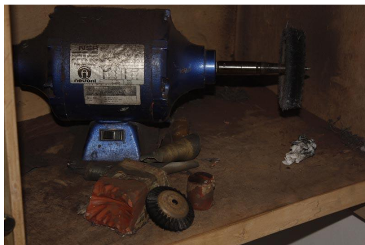
Figura 29. Motor de pulimiento tipo esmeril (3500 rpm).
