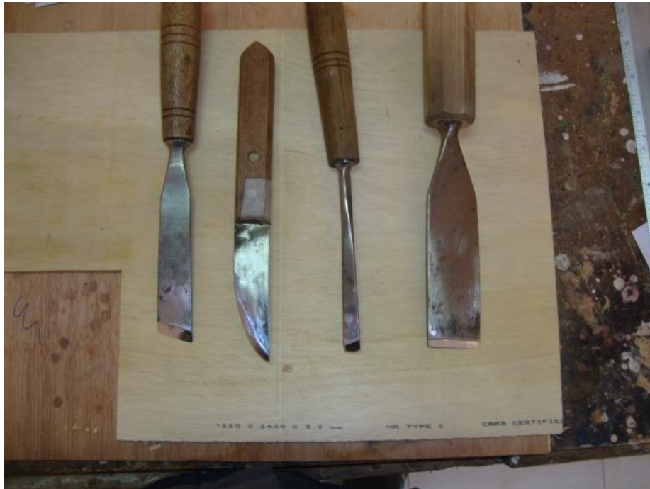
Figura 32. Gubia, cuchillo, buril y formón.
