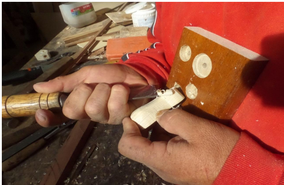
Figura 146 y 147. El uso de la gubia es importantísimo para dejar los huecos del tamaño de los imanes que irán encajados.
