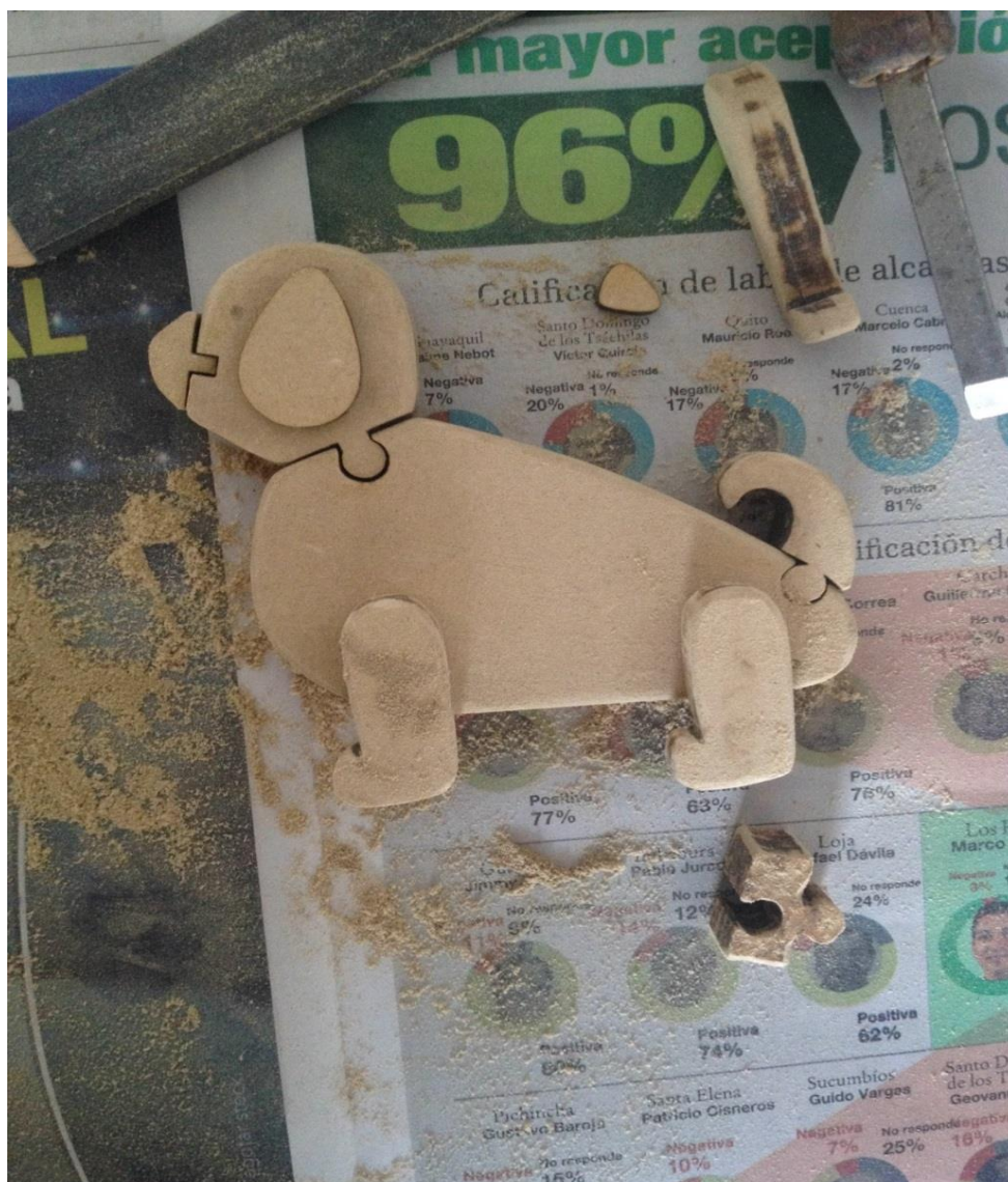
Figura 126. Prueba de sistema de unión. Encaje tipo rompecabezas.
