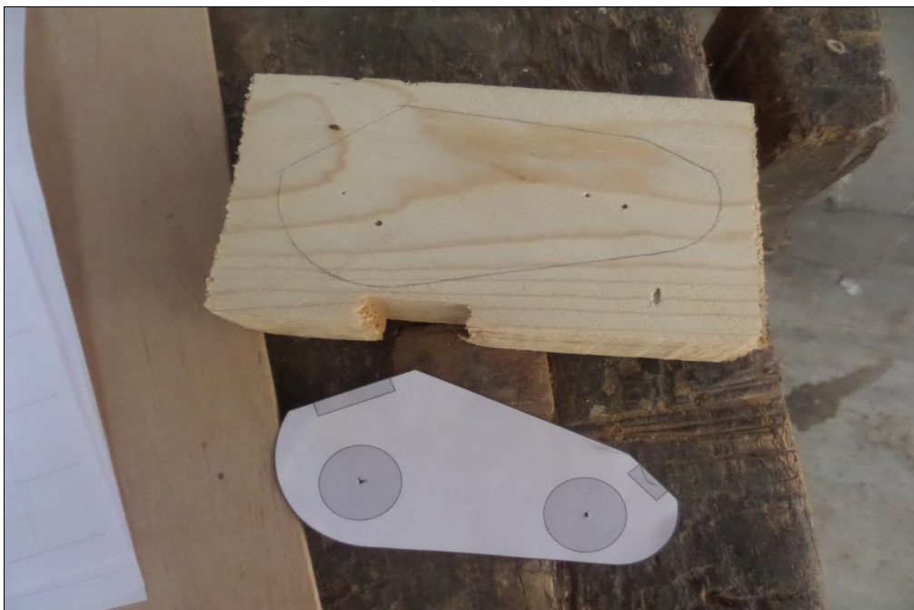
Figura 137. Marcar el centro donde irán incrustados los imán
