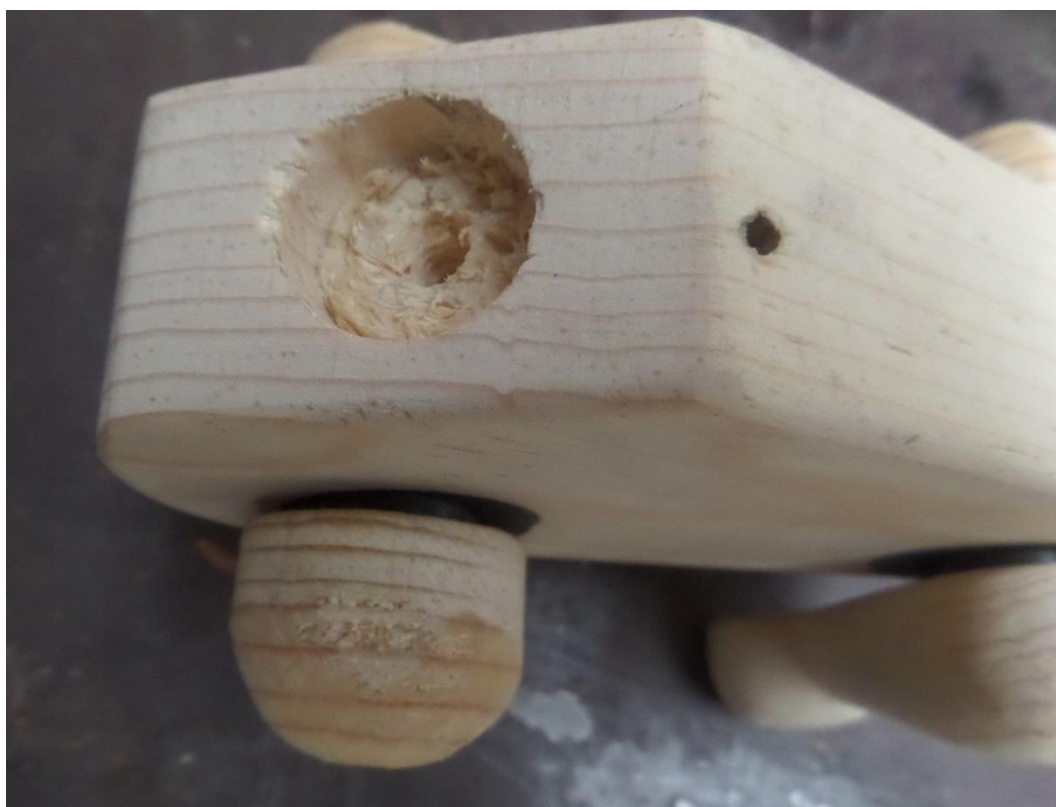
Figuras 130 y 131. Huecos en piezas para encaje de imanes.
