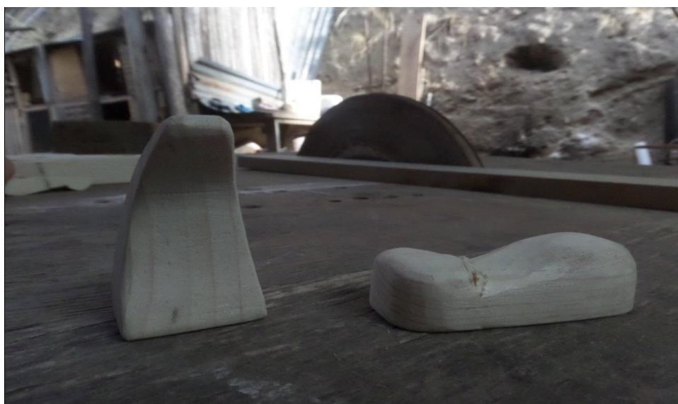
Figura 148. Paso 9: Se da las formas finales a las piezas y se pasan 3 niveles de lija para dejar la superficie lisa y brillante.
