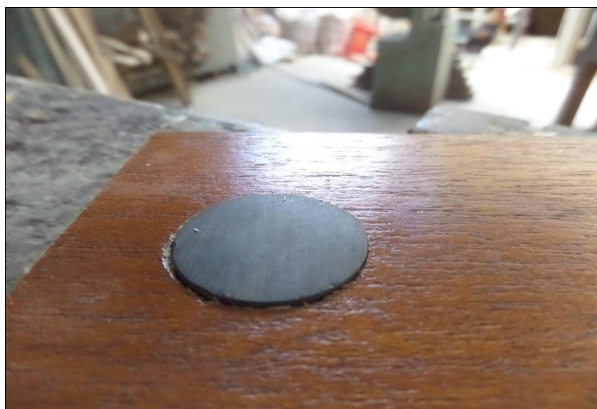
Figura 139 y 140. Paso 5: Se crea el espacio que sea exacto en ancho y en profundidad del imán.
