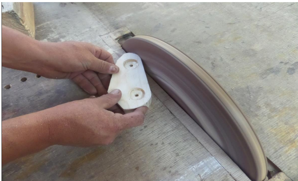
Figura 143. Paso 7: Se procede a lijar las esquinas para definir y pulir la forma de la pieza.
