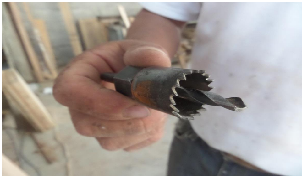
Figura 138. Paso 4: Con brocas del diámetro más cercano a la dimensión del imán, se procede a comer la madera con una broca “saca-bocados”.
