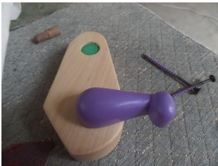
Figura 155 y 156. Paso 12: Se pasa un trapo con laca de agua o el color que se desee dar a las partes y tenemos el juguete terminado y listo para armarse y desarmarse.
