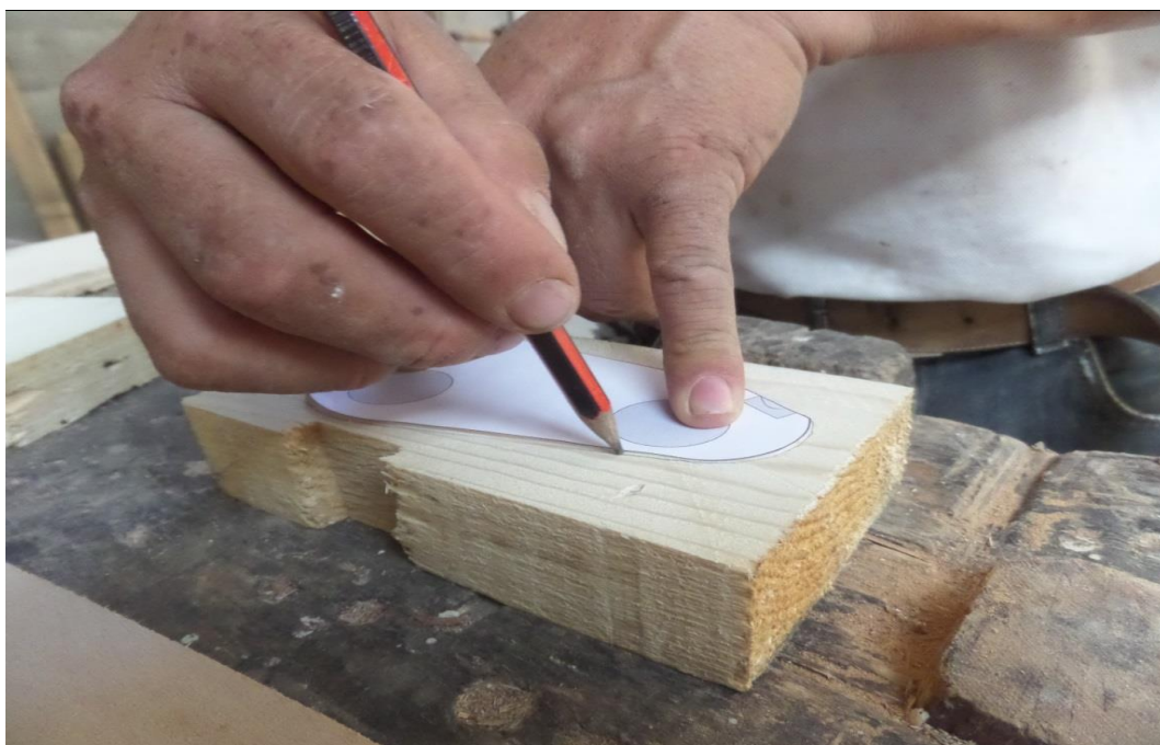
Figura 136. Paso 3: Marcar el centro donde irán incrustados los imán.
