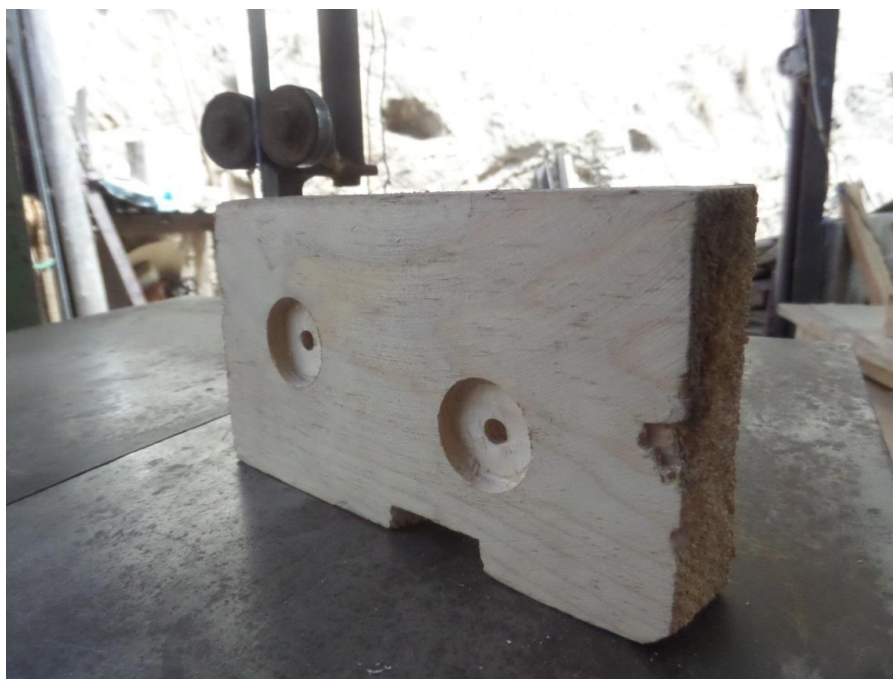
Figura 129. Huecos en piezas para encaje de imanes.
