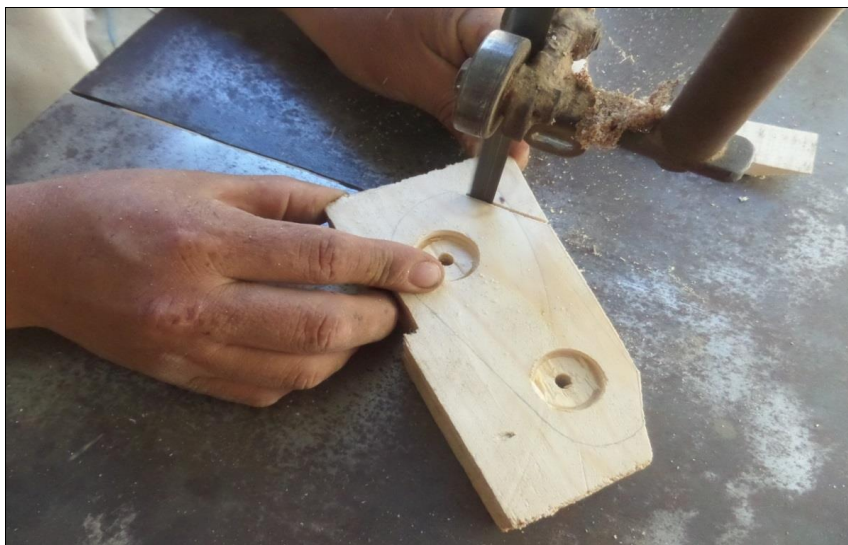
Figura 141. Paso 6: Una vez hecho los huecos, se deja los imanes de lado y se procede a calar las piezas de la plancha de madera de 3cm de espesor.
