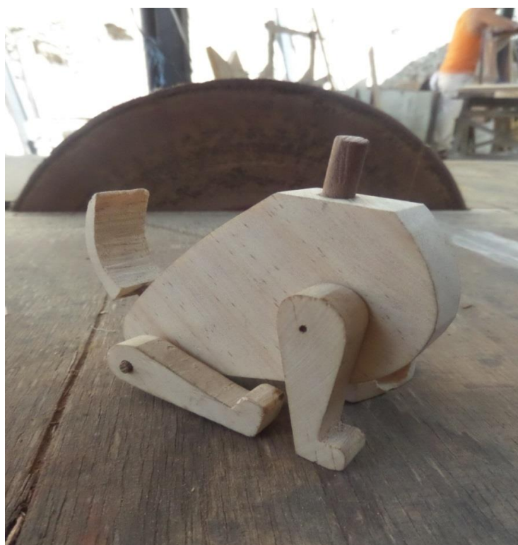
Figura 127 y 128. Prueba de sistema de unión. Encaje con tarugos.
