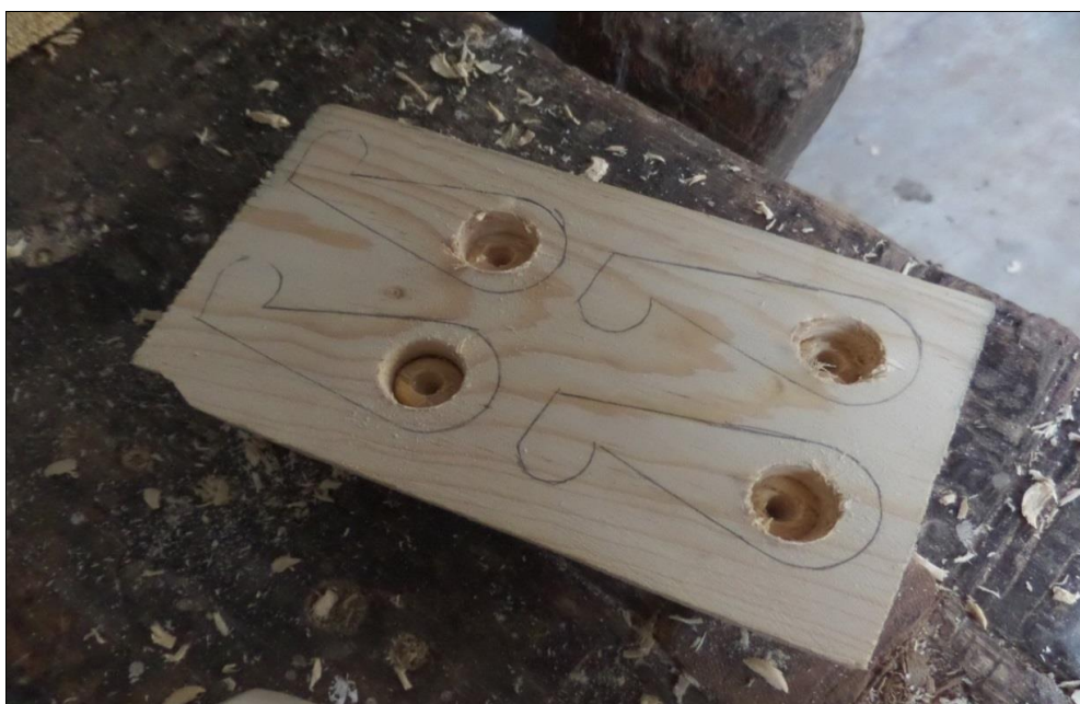
Figura 142. Este proceso se realiza en todas las piezas. Dependiendo su espesor se utiliza la plancha que le corresponda. El hueco se hace antes de que las piezas estén sueltas.
