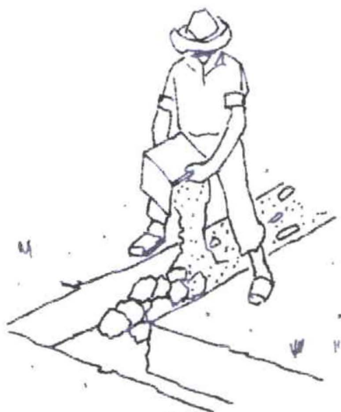
DC2 Preparación de la base del cemento
