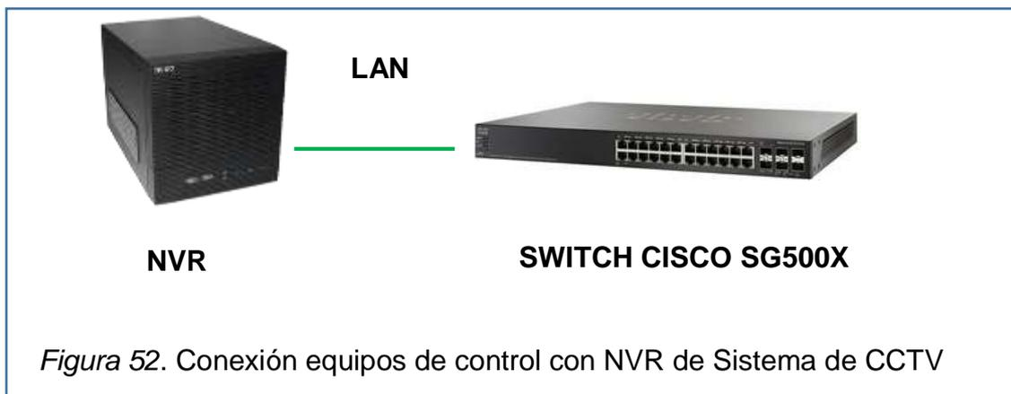
El Network Video Recorder (NVR) tiene una conexión a un punto de datos, el mismo que se conecta al **Switch Cisco SG500X** por medio de un cable UTP Cat. 6A del sistema de cableado estructurado.
