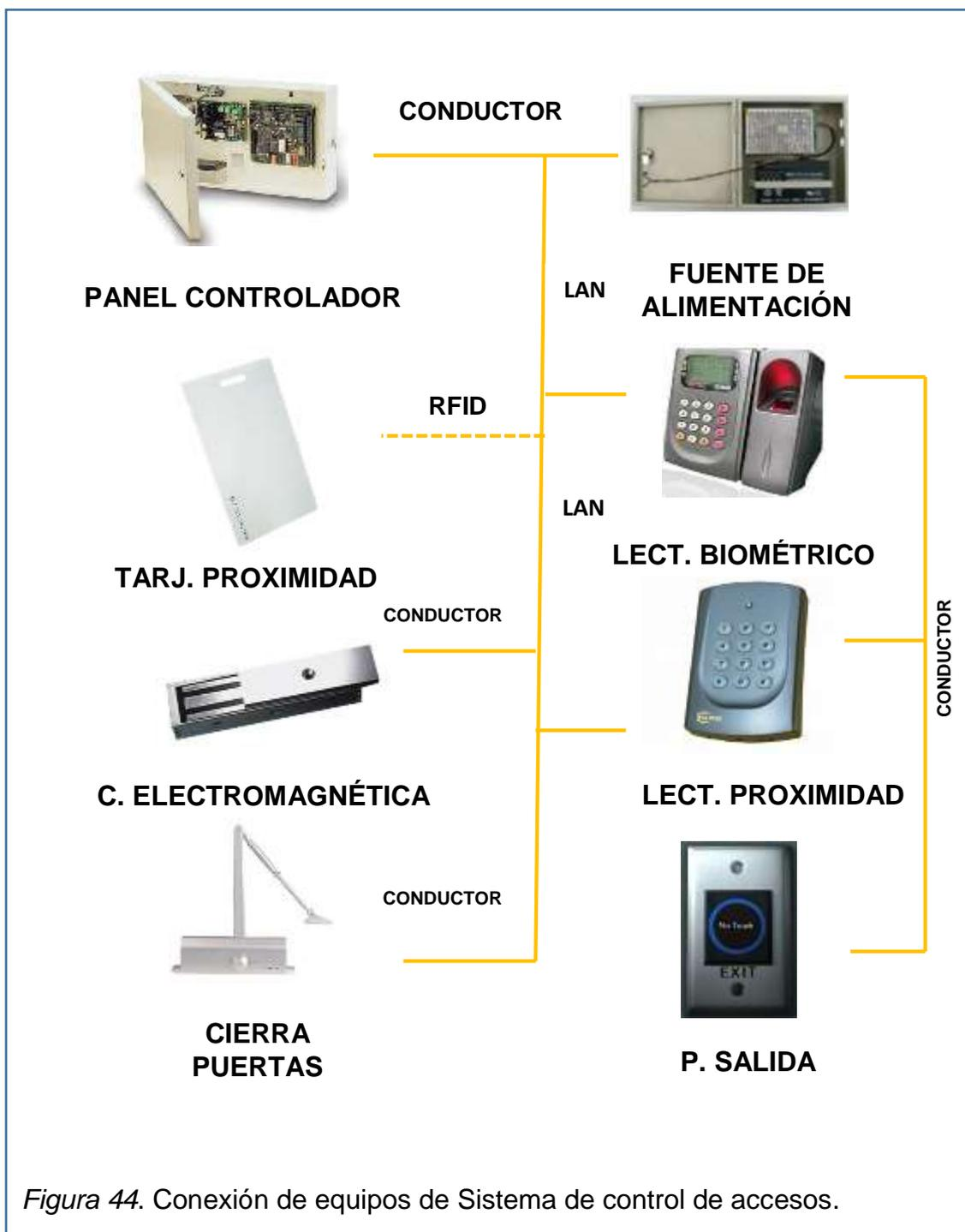
Figura 44. Conexión de equipos de Sistema de control de accesos.
