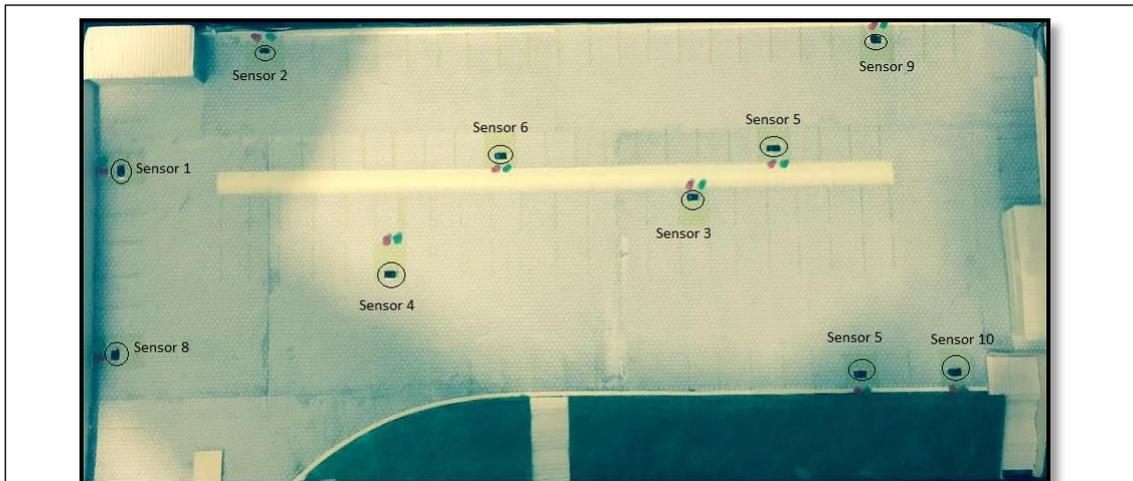
*Figura 37.* Maqueta parte superior con ensamblaje electrónico (Sensores, Leds).
