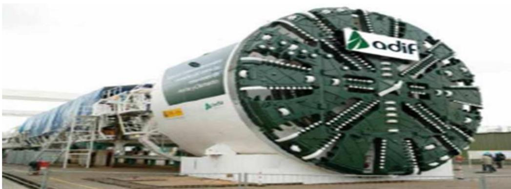
**Figura 40:** TBM con escudo simple, utilizada en el túnel de Madrid.
