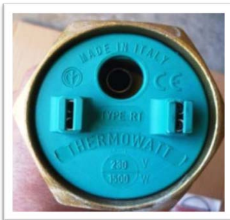
Figura 7. Resistencia calentadora electrica vista superior
