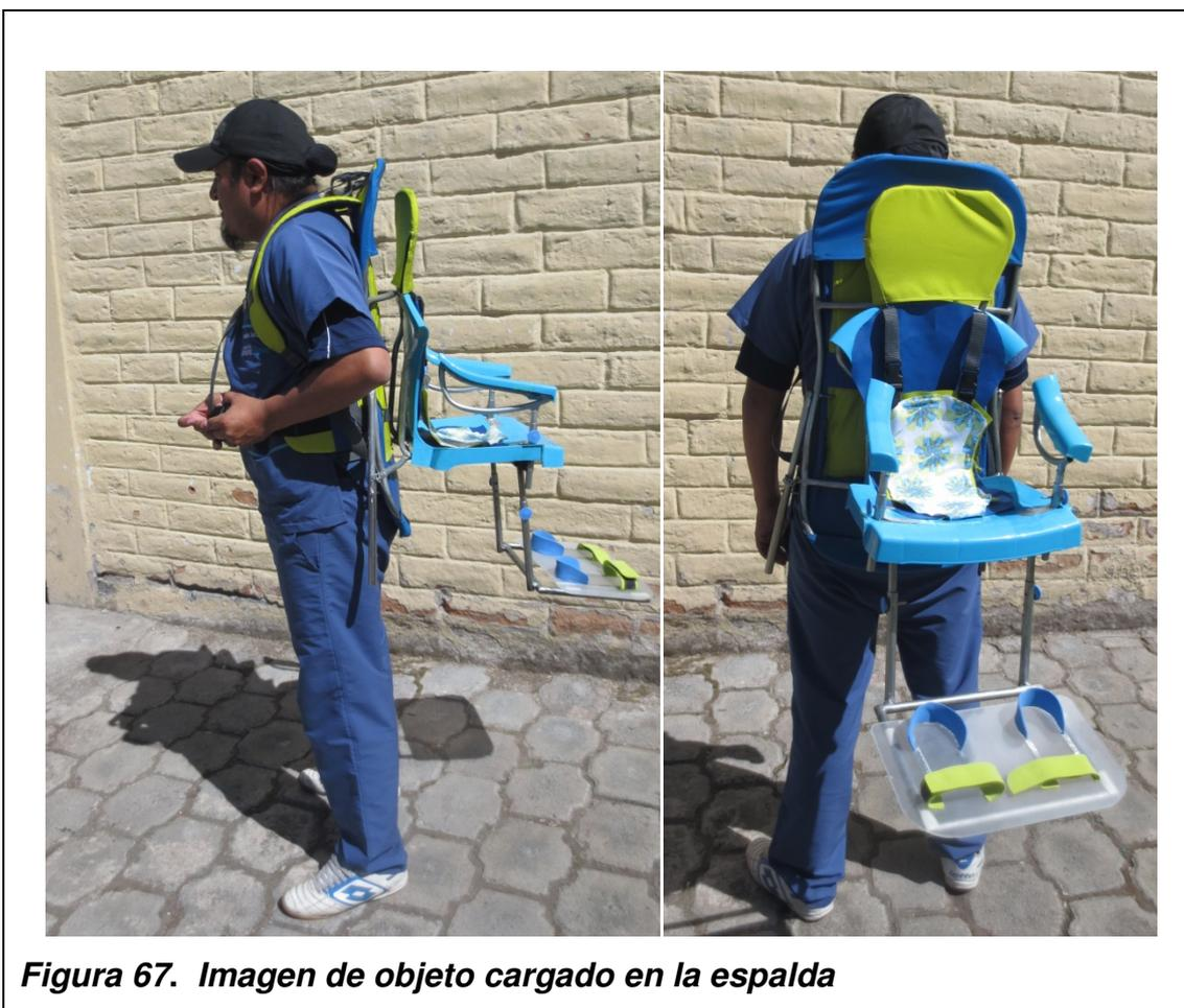
**Regulable.-** La distancia y altura de los apoya brazos y apoya pies son regulables mediante un mecanismo de ajuste vertical que se modifica con el uso de una pieza semejante a la de un tarugo. La distancia entre las piernas es
