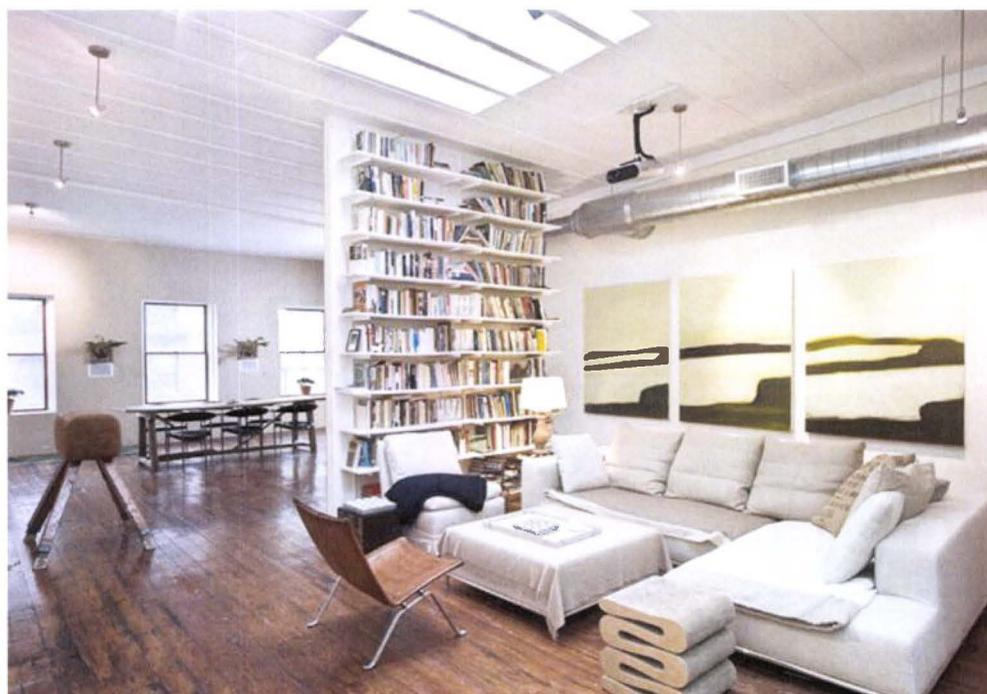
FIGURA 78 (Ameduri, 2010) Claraboyas de Luz Aplicación de tragaluces cenitales para ayudar con la iluminación, uso de materiales como el metal para reflexión, pisos de madera.
