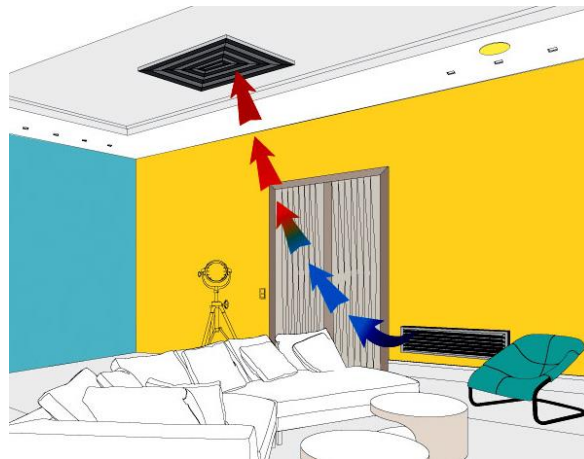
Figura 70. Esquema de inyección y extracción de aire.
