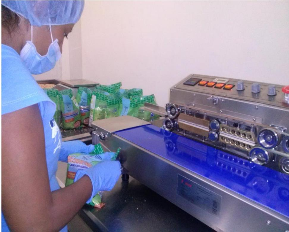
**Figura 13.** Proceso de sellado de las fundas de granola
