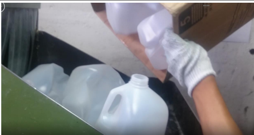
Figura 26. Producto defectuoso siendo ingresado al molino.
