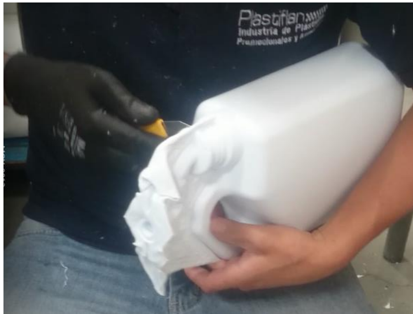
Figura 23. Sobrante de material del envase o colada.
