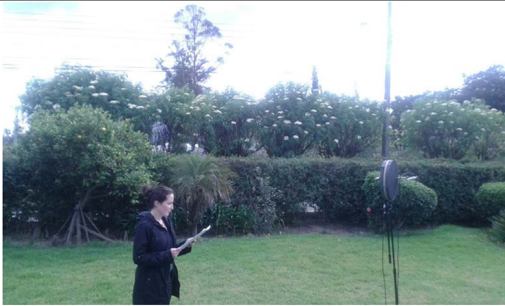
Figura 36. Grabación de voces laterales con el sistema Jecklin Disc en ambientes propios del escenario
