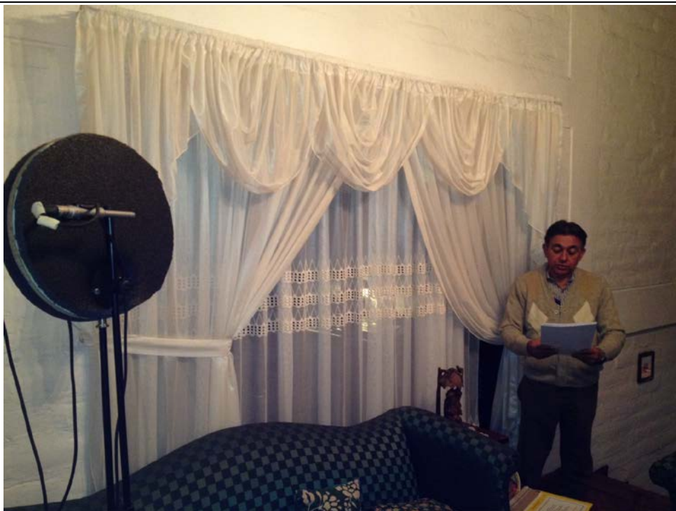
Figura 37. Grabación de voces laterales con el sistema Jecklin Disc en ambientes propios del escenario
