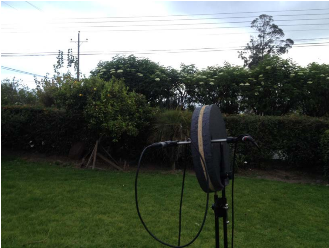
Figura 41. Grabación de sonido ambiental con Jecklin Disc en una segunda locación
