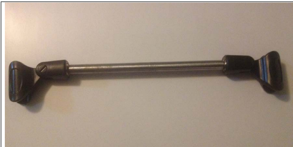
Figura 32. Detalle del brazo que sujetará a los micrófonos a cada lado del disco con sus respectivas pinzas
