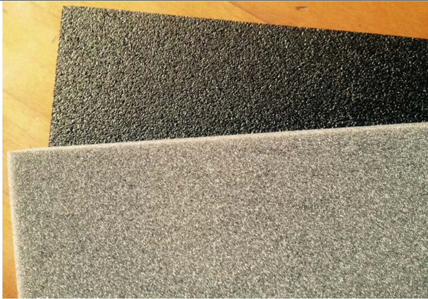
Figura 31. Placas de esponja fonoabsorbente con película de poliuretano utilizadas para el montaje del Jecklin Disc
