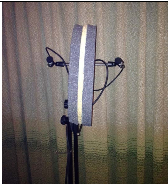
Figura 33. Detalle del montaje del sistema Jecklin Disc terminado y colocado sobre un pedestal
