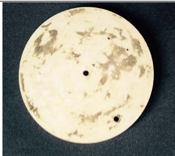
Figura 30. Disco de madera que se utilizará para el montaje del Jecklin Disc con los respectivos agujeros. Los agujeros más pequeños servirán para la fijación del pedestal.
