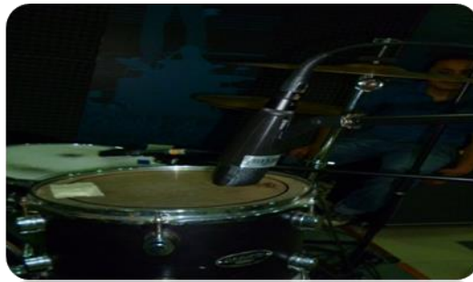
Figura 5. Posicionamiento de micrófonos en el Tom.
