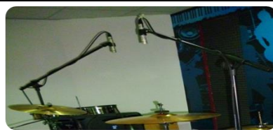
Figura 1. Técnica par espaciado
