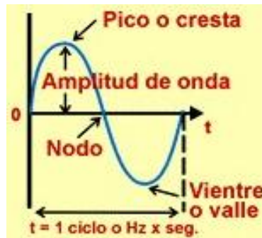
Figura 2.3 Amplitud, pico, valle y nodo de una onda de un ciclo.
