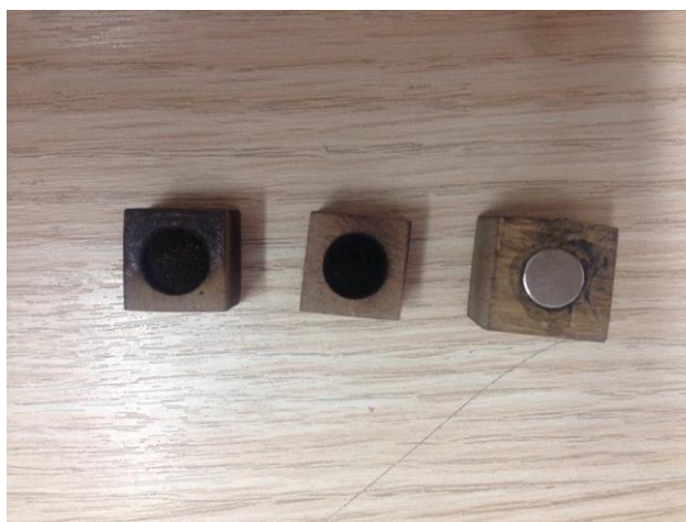
Figura 38. Prueba de corte de tablero MDF a mano y corte láser
