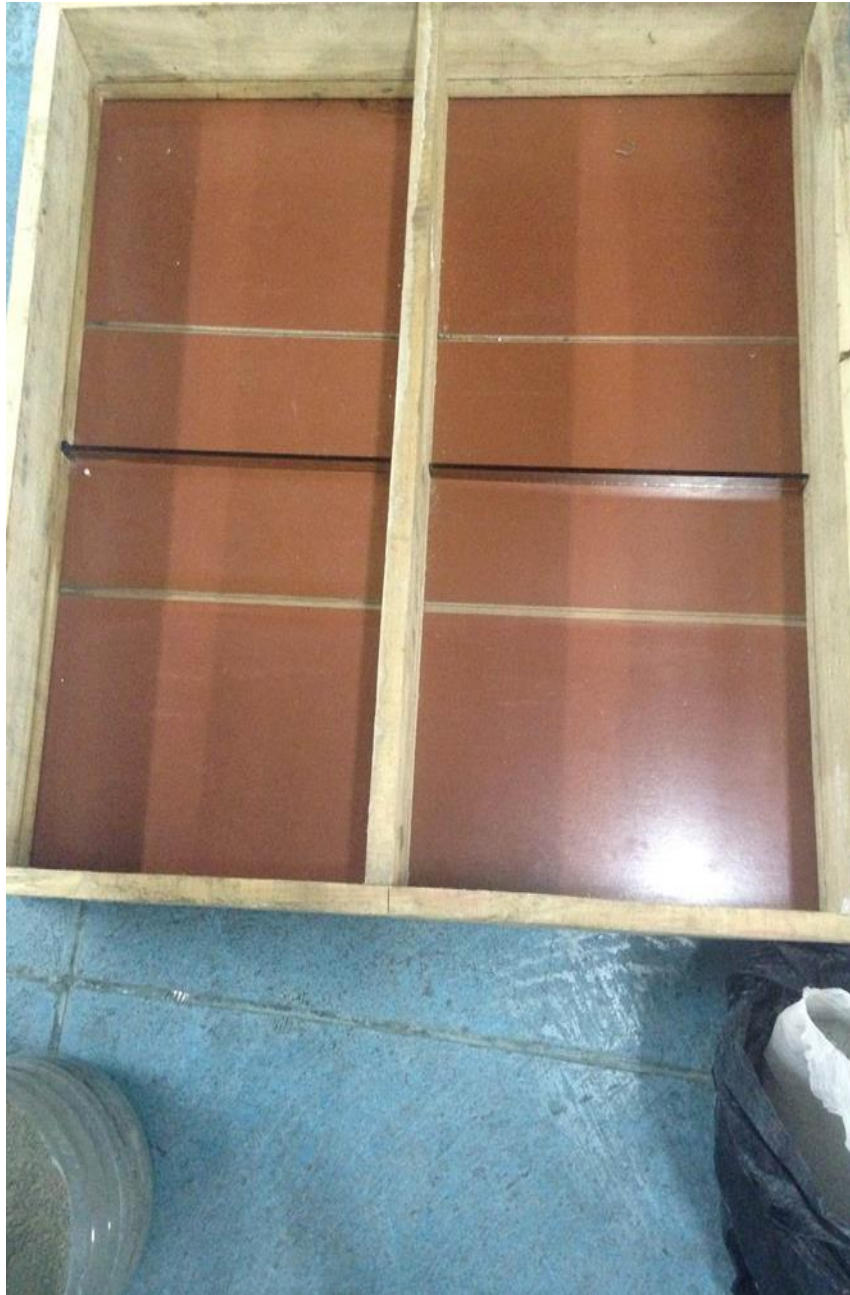
Figura 32. Encofrado, 30 x 30 cm, espesor 2 cm
