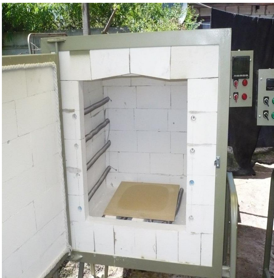
Figura 20. Horno vidrio – parte interna
