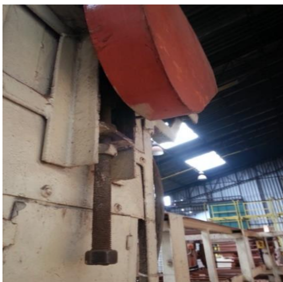
Figura 87. Tornillo regulador de altura del rodillo
