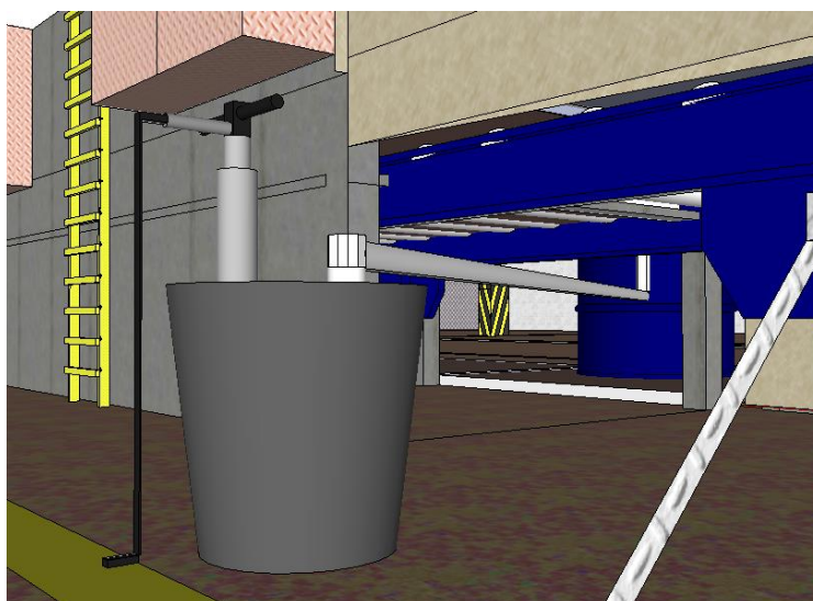
Figura 81. Conexión entre balde recolector y barril de pintura
