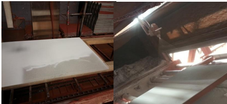
Figura 58. Ejemplos de placa mal pintada
