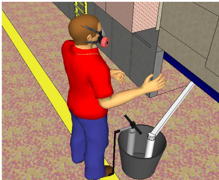
Figura 80. Bomba manual y Posición del operador.
