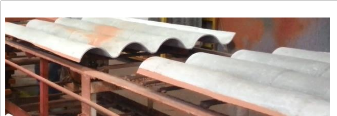
Figura 93. Alimentación de placas a una distancia de 23 cm
