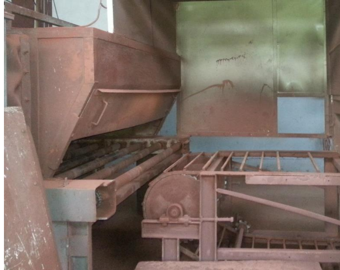
Figura 92. Salida de la cabina de pintado
