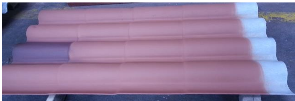
Figura 60. Placa con pintado incompleto debido a placas montadas
