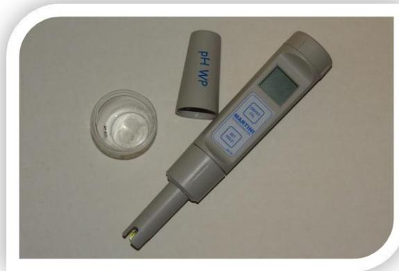
**Figura 9.** Medición de pH salival con pHmetro digital
