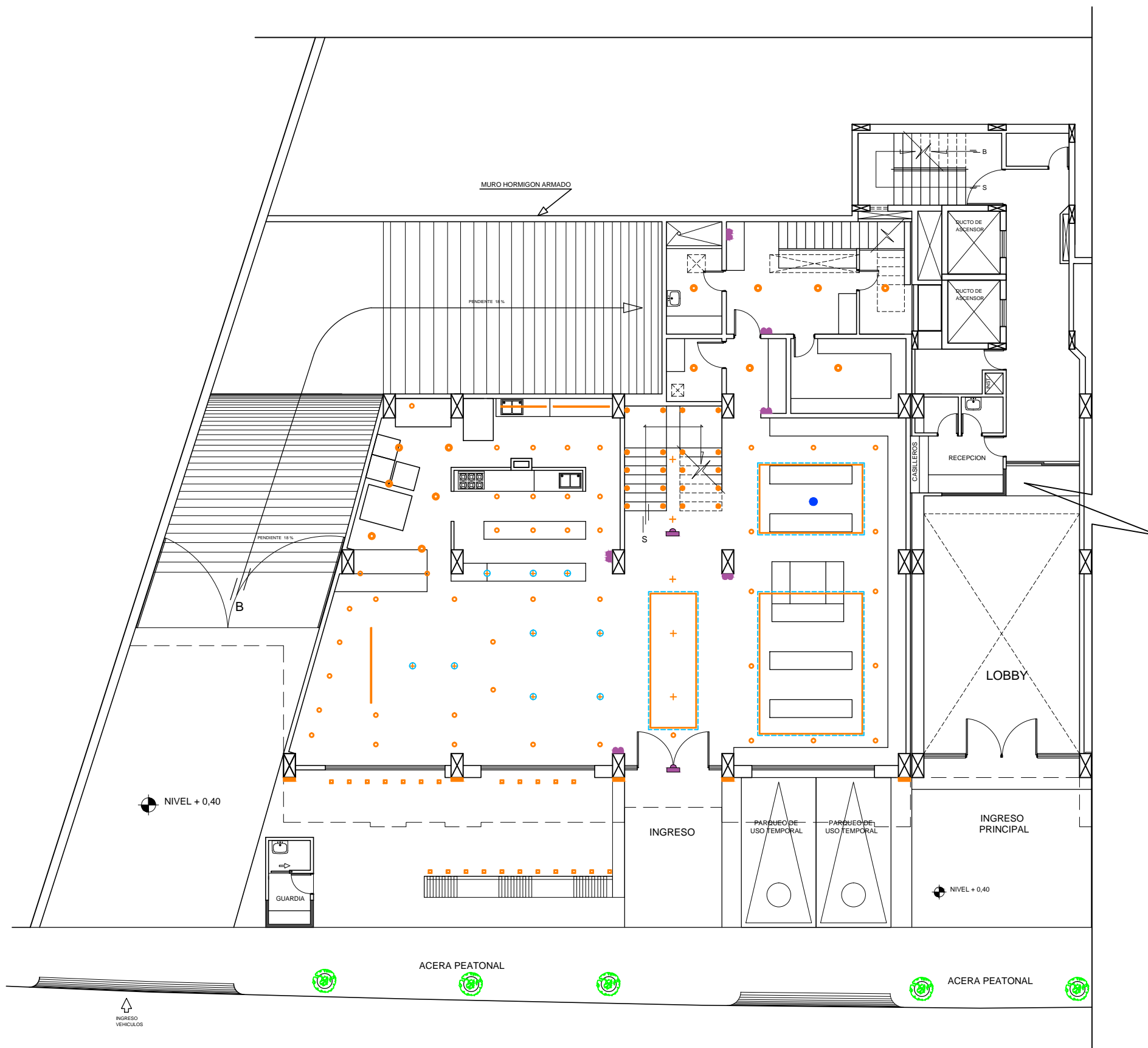
SUB-SUELO 1 NIVEL + 0,40 ESPECIFICACION ILUMINACION ESCALA: 1:150
