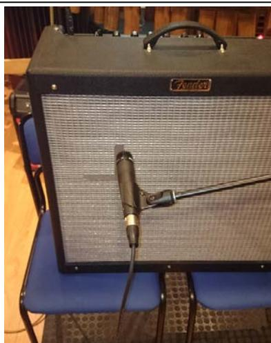
*Figura 82.* Posicionamiento de micrófonos durante la grabación de técnica 1 en guitarra.
