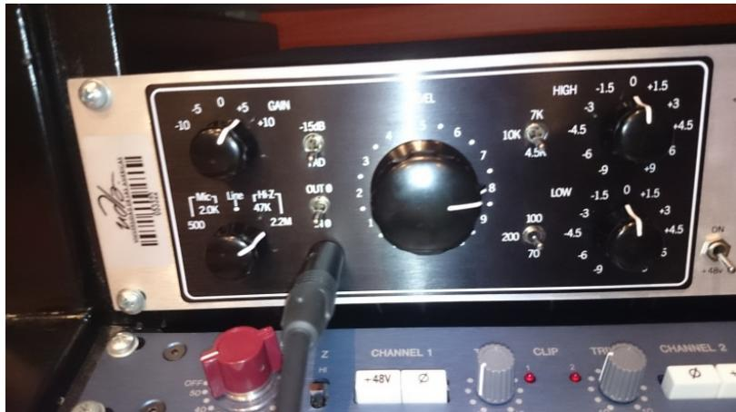
*Figura 100.* Conexión y parámetros del preamplificador 6176 durante la grabación de técnica 10 en bajo.
