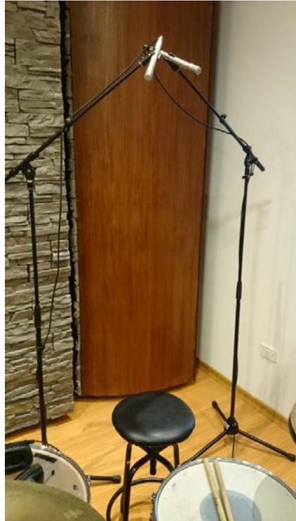
*Figura 109.* Posicionamiento de micrófonos SM81 en configuración ORTF durante grabación de técnica 9 de batería.
