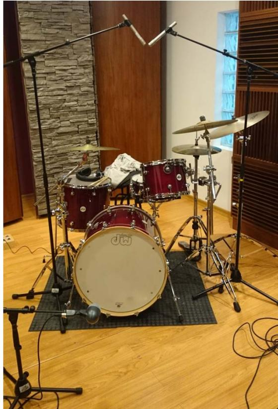
*Figura 106.* Posicionamiento de micrófonos alrededor de la batería durante grabación de técnica 6.
