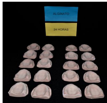
Figura 79. Modelos de yeso tipo IV vaciados a las 24 horas obtenidos de Alginato (Hydrogum 5, Zhermack)
