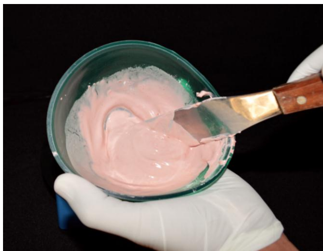
Figura 76. Mezcla de Yeso Tipo IV con espátula metálica en taza de goma.
