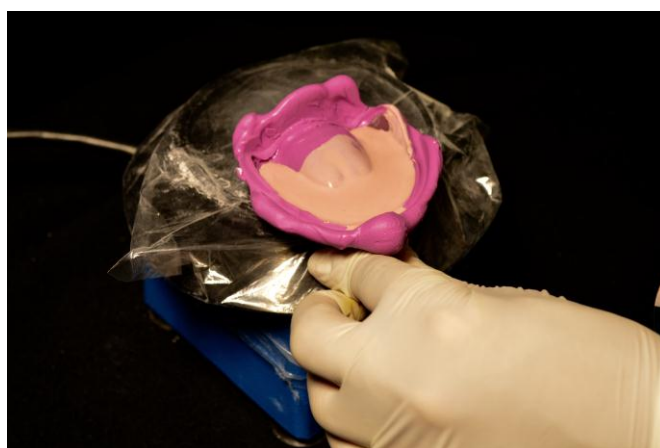
Figura 77. Eliminación de Burbujas de Yeso Tipo IV en la Impresión de Alginato (Hydrogum 5, Zhermack) a las 24, 48 y 72 horas
