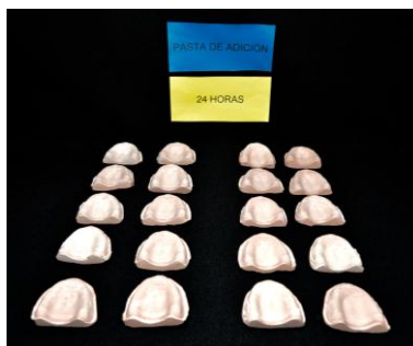
Figura 62. Modelos de yeso tipo IV vaciados a las 24 horas, obtenidos de Silicona de Adición (Express, 3M ESPE)
