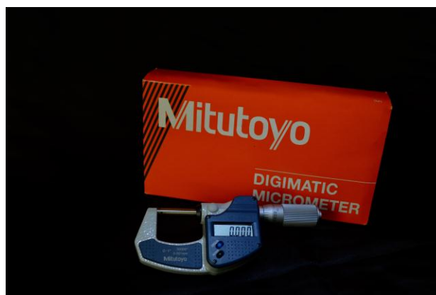
Figura 37. Micrómetro Digital (Mitutoyo Digimatic MDC-1" SXF 293-832-30)
