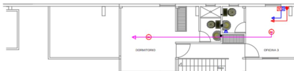
Figura 51: Plano de la planta alta 1 de la oficina matriz con la señalética de puntos de voz, datos y cámaras de seguridad.
