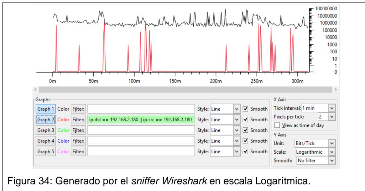
Figura 34: Generado por el *sniffer Wireshark* en escala Logarítmica.
