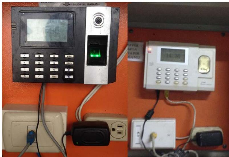
*Figura 41: Accesos Biométricos, izquierda: Lectora de huellas digitales, derecha Tarjeta RFID.*
