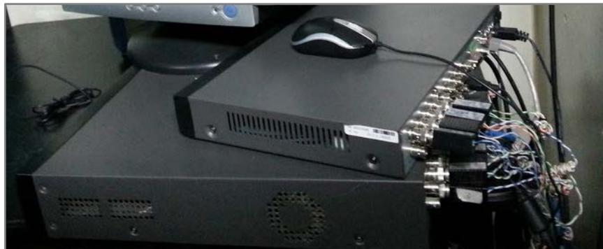
*Figura 43: Conexión de DVR Hik-Vision DS-7316HI-S en el cuarto de equipos.*
