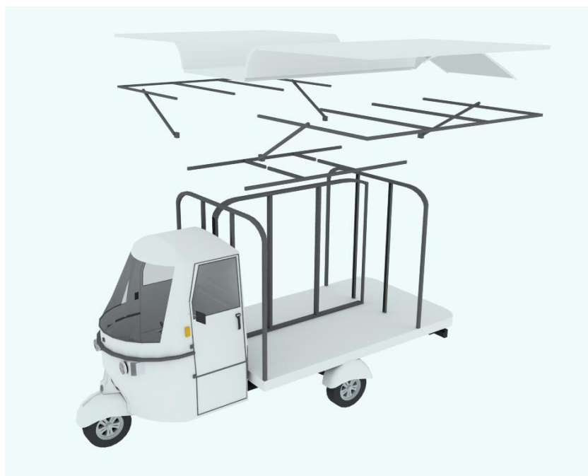
Figura 94. 3D Explosión de la estructura interna.
