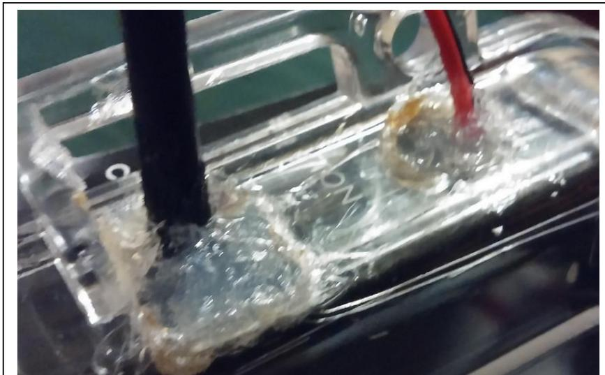
*Figura 41.* Conexión del cable Tipo A/B y cable de poder.
