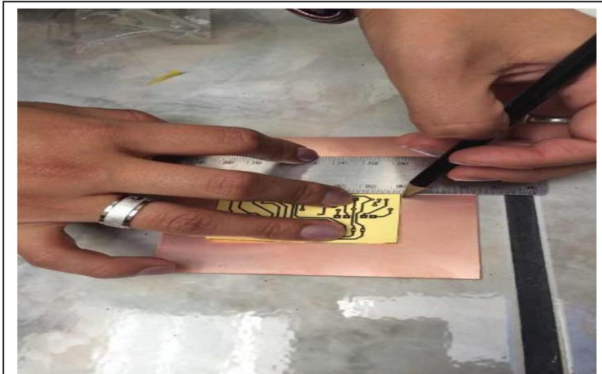
*Figura 16.* Dimensionamiento en el PCB.
