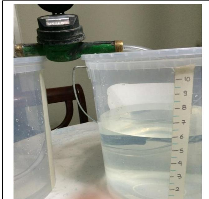
*Figura 50.* Paso del agua con el medidor analógico.
