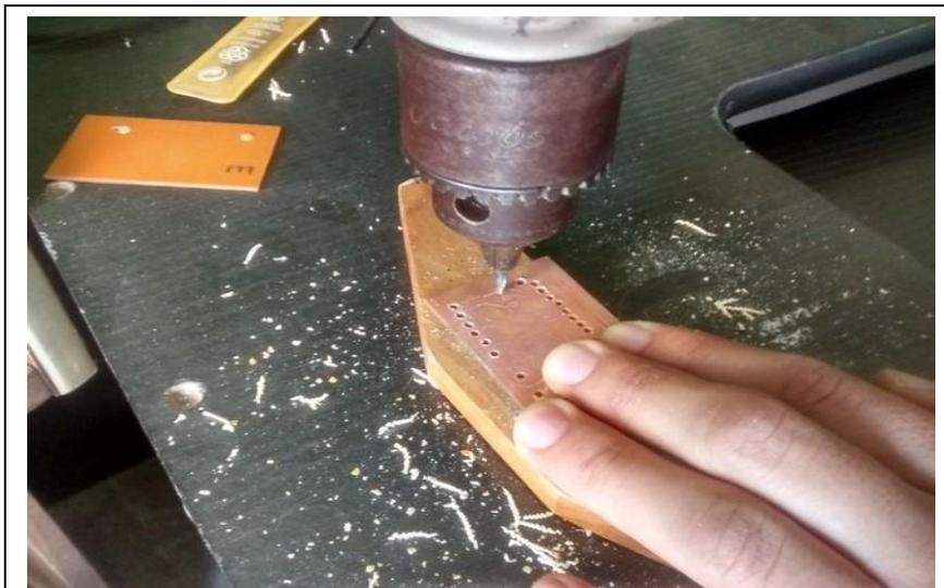
*Figura 31.* Perforación del PCB.
