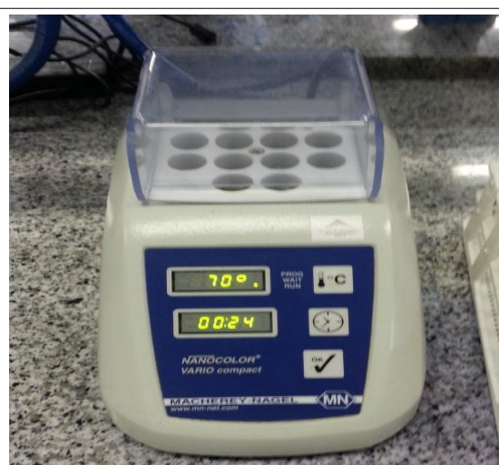
Figura 13. Estufa utilizada en la digestión de los individuos
