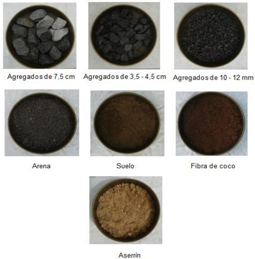
Figura 7. Materiales utilizados en la estratificación de los vermifiltros.
