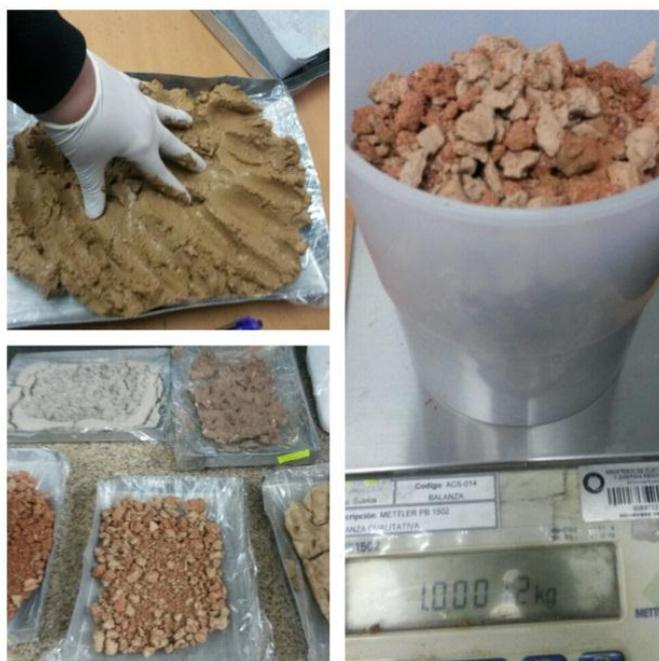
**Figura 6.** Preparación muestras de lodo
