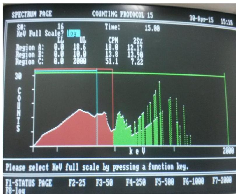
Figura 88. Espectro SB32 escala logarítmica
