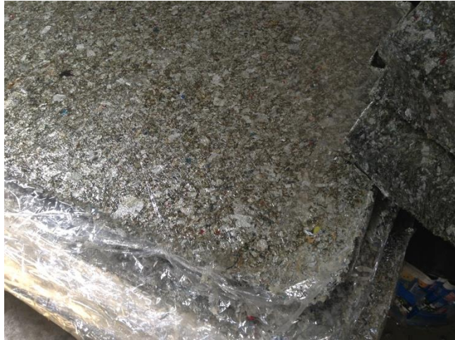
Figura 22. Panel de Polialuminio, producto listo, previo al cortado.
