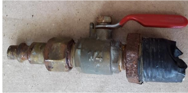
Figura 12. Regulador de flujo: válvula de esfera para agua 7 ¼ mm.
