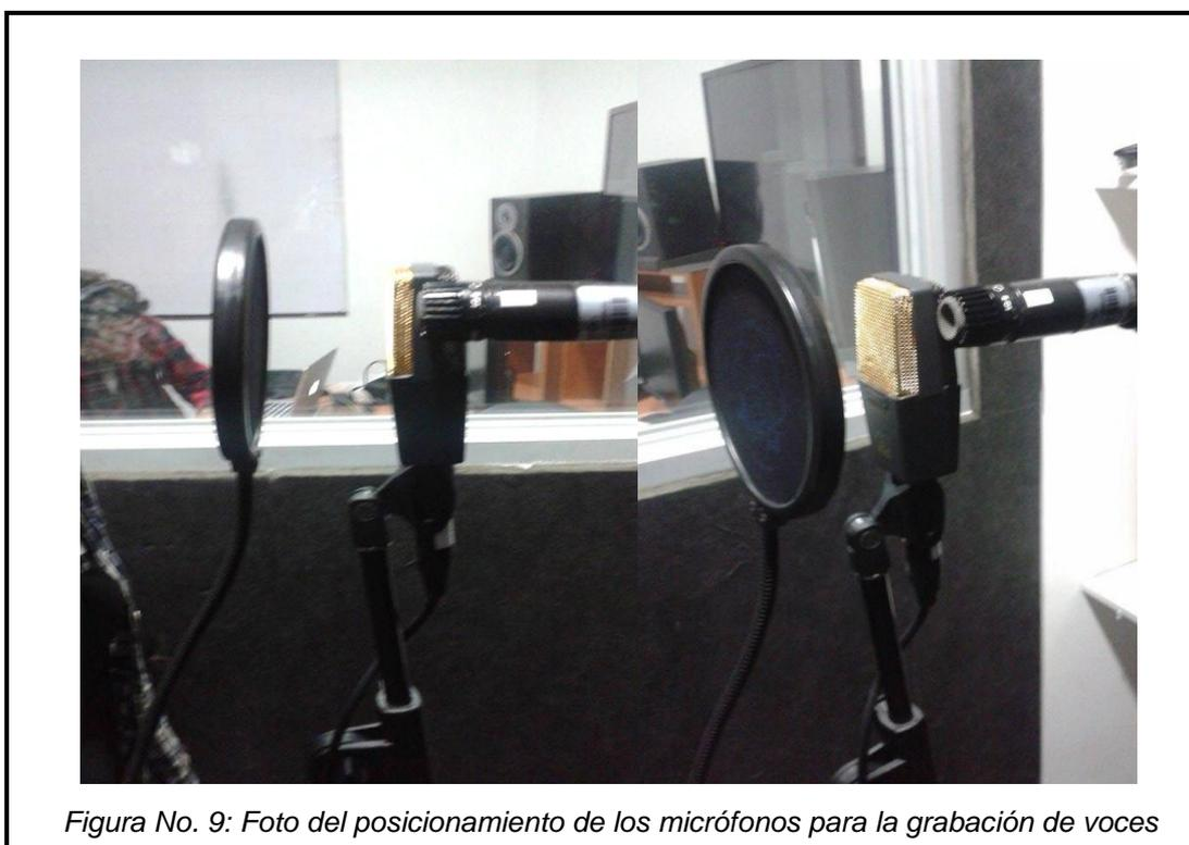
Se decide utilizar dos micrófonos con distintas cualidades para contar con dos señales de sonoridades diferentes en la mezcla; una señal más nítida y con más cuerpo, captada por el AKG C414 XLII, y una señal de refuerzo para las frecuencias altas para tener un sonido más brillante, captada por el SHURE SM57.
