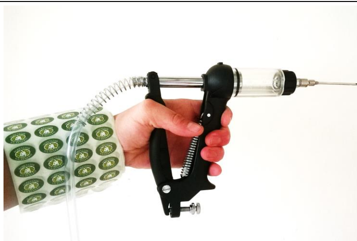
Figura 8. Método de inyección con pistola automática y manga de adhesivos para protección de planta.
