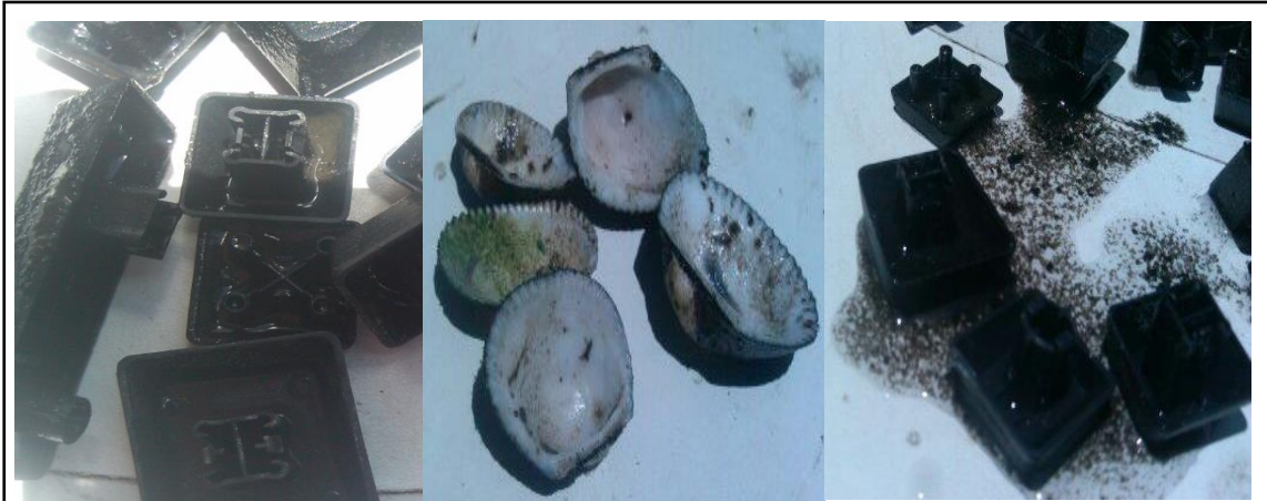
Figura 24. Formación de biopelícula en lechos fijos.
