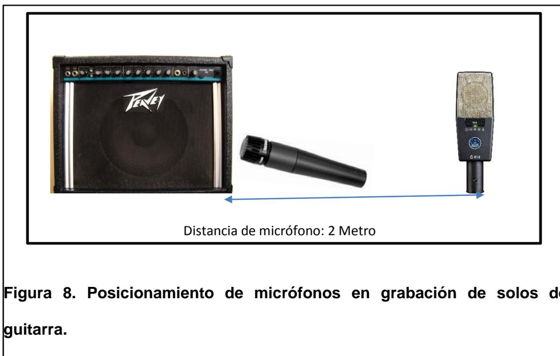
**Figura 8. Posicionamiento de micrófonos en grabación de solos de guitarra.**
