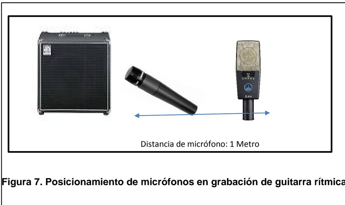
**Figura 7. Posicionamiento de micrófonos en grabación de guitarra rítmica.**
