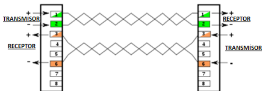
Figura 8. Como se intercambian los emisores con receptores para un crimpado.
