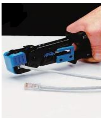
Figura 12. Crimpado de cable. Tomado de Jerri Farris, 2008, p. 57.
