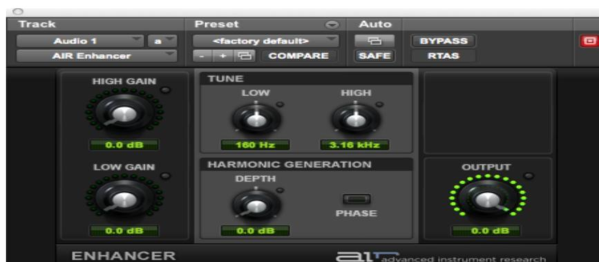
Figura 54. Interfaz gráfica del potenciador de frecuencias *Enhancer*
