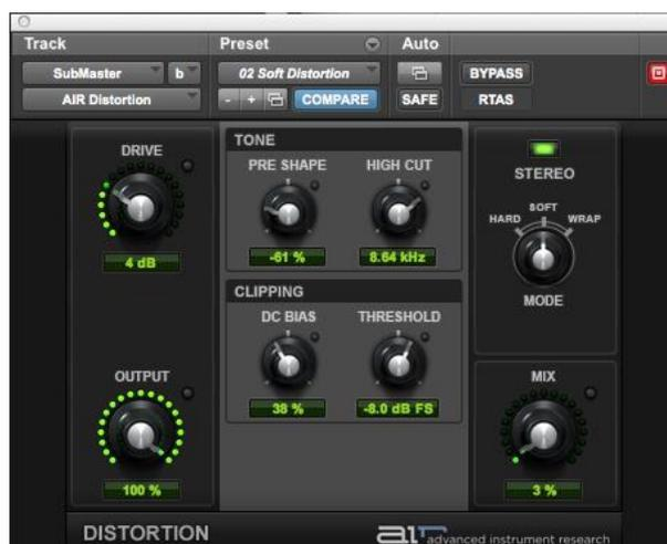
Figura 59. Interfaz gráfica de la distorsión *Distortion*
