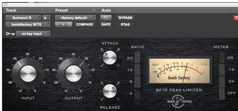
Figura 47. Interfaz gráfica del compresor *Bomb Factory BF76*
