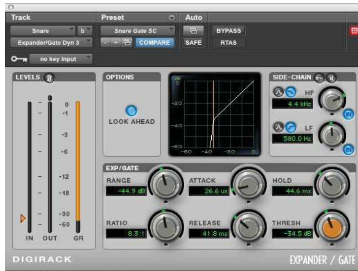
Figura 16. Compuerta usada en mezcla
