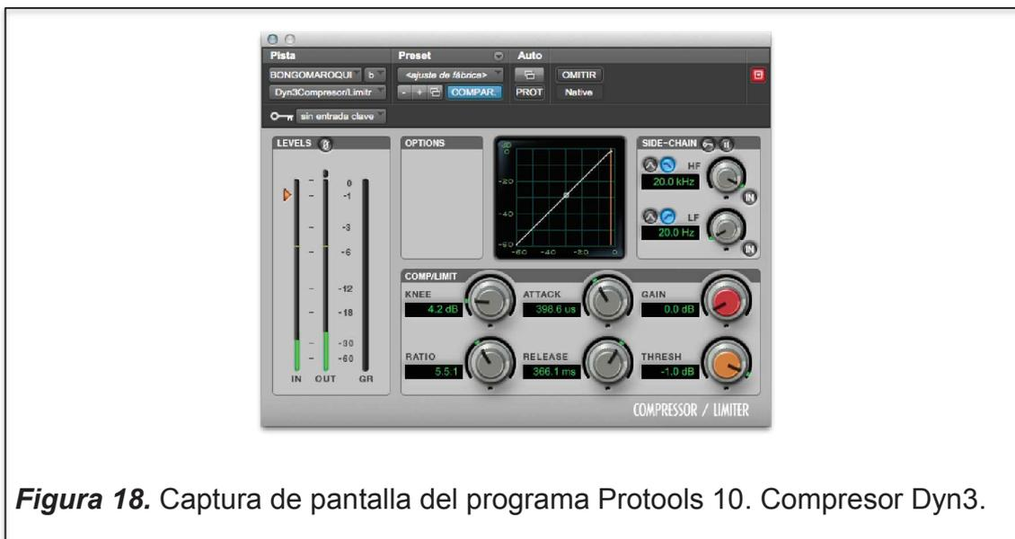
**Figura 18.** Captura de pantalla del programa Protools 10. Compresor Dyn3.
