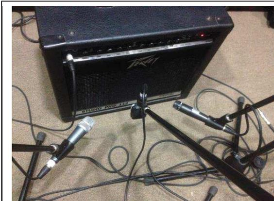
Fig. 9.- Amplificador con los tres micrófonos
