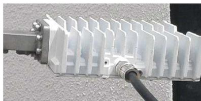
Figura 6. Foto de transceiver para enlace satelital
