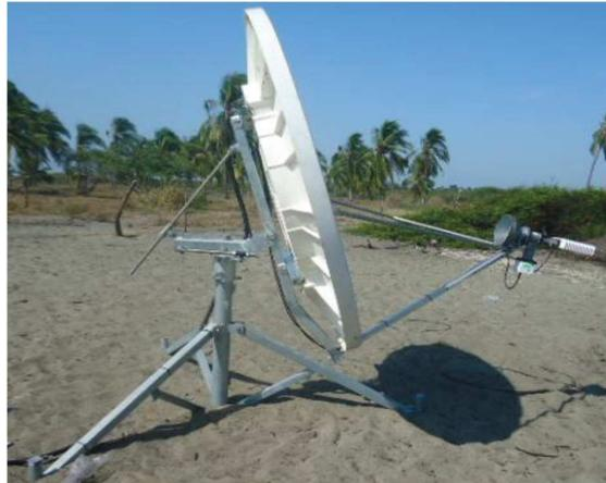
Figura 19. Estación terrena de VSAT en cliente ubicado en la Isla Puna
