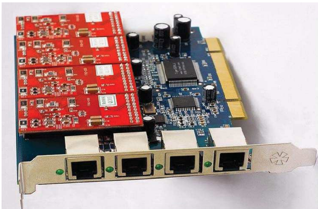
Fig. 2.4 Tarjeta TDM400p con 4 puertos FXO activos
