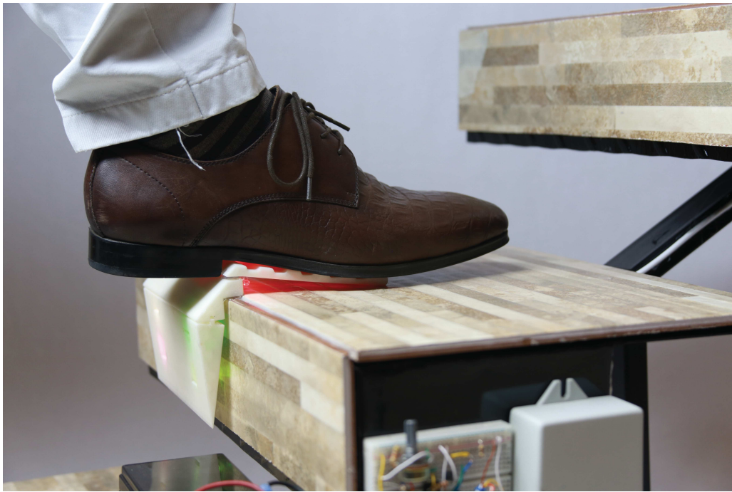
Figura 26. Antideslizante para Gradass con diodos LED
