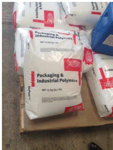
Figura 13. Polímero utilizado para la mezcla asfáltica
